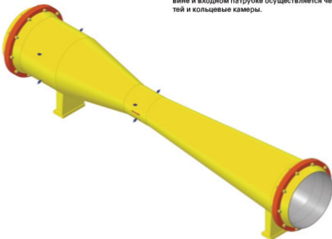
Трубы Вентури состоят из входного патрубка, на котором находятся кольцевая камера и отверстия для отбора давления, входного конуса, горловины, на которой также имеются отверстия, и диффузора. Отбор давлений в горловине и входном патрубке осуществляется через отверстия в стенках этих частей и кольцевые камеры.
